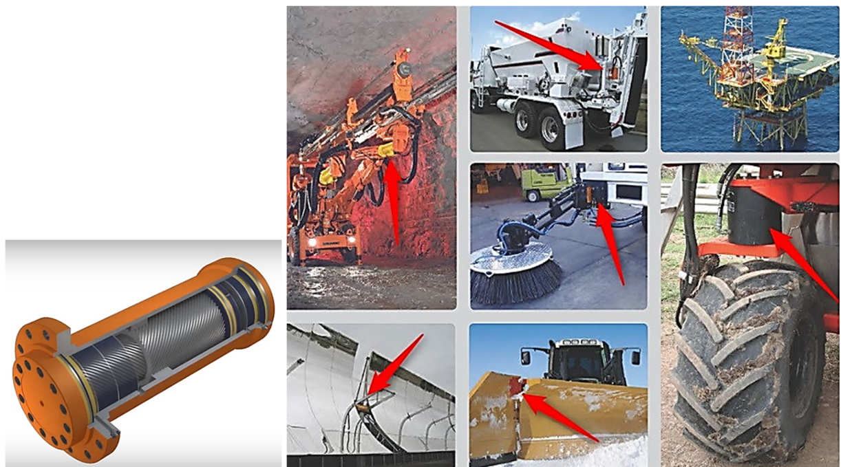
Figure.26. Vérin rotatif hydraulique à cannelure, domaines d'application.
