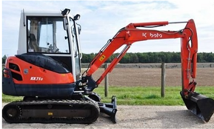
Figure.21. Présence des vérins hydrauliques au niveau des engins de bâtiment et travaux publics.
